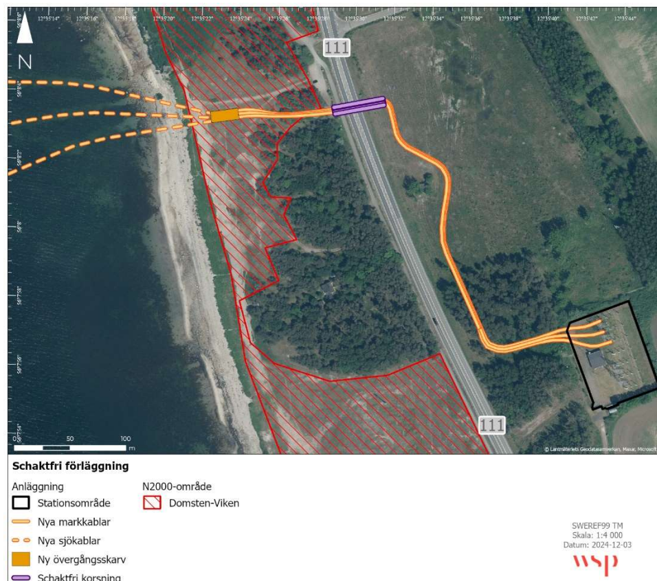
Figur 2.1:7. Schaktfri förläggning vid korsning av väg 111.
