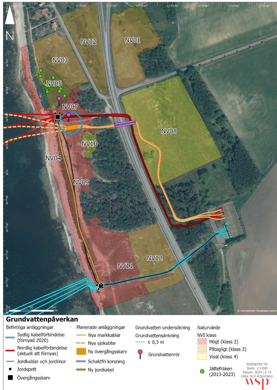
Figur 3.2:1. Karta över påverkansområde för grundvattensänkning relaterat till schaktningsarbete vid övergångsskarv.
